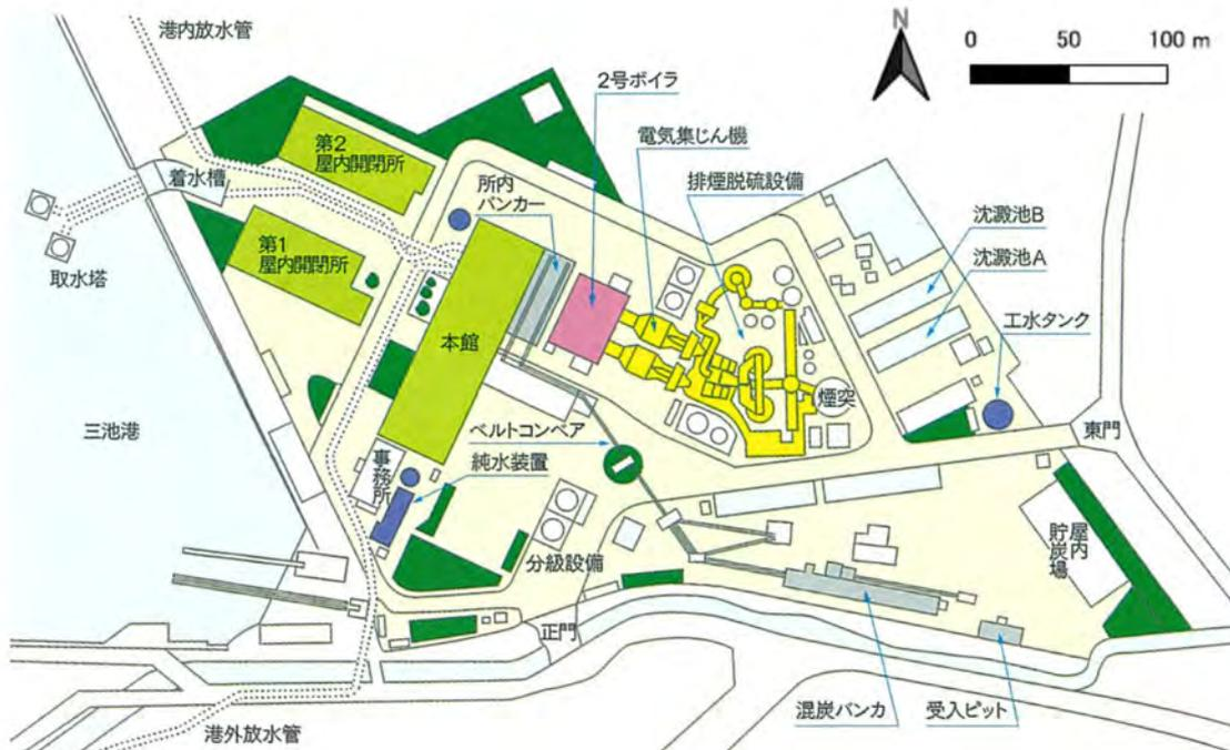
図 2.2-3(1) 発電所の配置計画の概要（現状：2024年）
